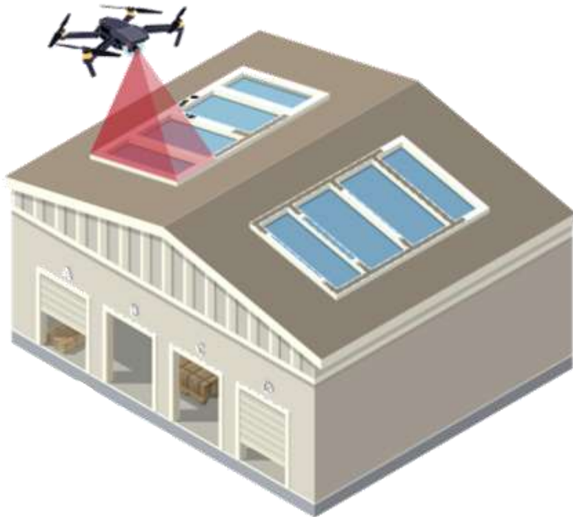
Inspección automatizada del techo del almacén mediante drones.
